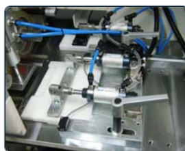
Trois (3) cylindres presseurs de chaque côté pour une meilleure stabilité de la pièce
