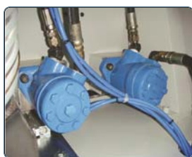
Moteur hydraulique indépendant pour l'entraînement
