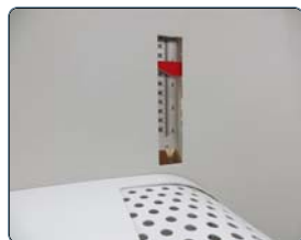
Indicateur de positionnement pour l'élévation des rouleaux presseurs
