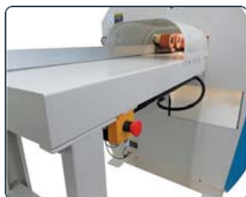
Tunnel à la sortie et bouton d'arrêt d'urgence
