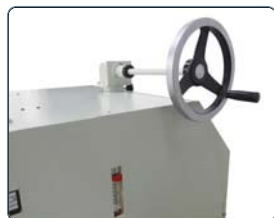
Volant d'élévation des rouleaux presseurs facilement accessible à l'opérateur
