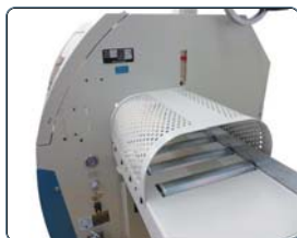
Tunnel à l'entrée en conformité avec la réglementation en vigueur au Québec
