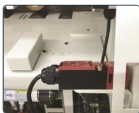
Interrupteur de sécurité permettant un arrêt immédiat de la machine à l'ouverture du cabinet
