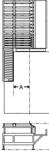
Le **BTRS-69** retourne le matériel devant être déligné à nouveau directement sur la table de la scie. Les délignures (à la droite de la ligne de coupe) tombent dans une réserve. La réserve peut être remplacée au besoin, par un convoyeur à courroie. La table de la déligneuse doit être modifiée si la distance "A" est plus longue que 18".
